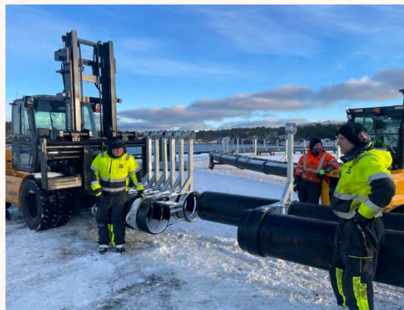
Grønn plattform: Nye klammere blir tredd innpå de resirkulerte flytekragene. Foto: ScaleAQ
